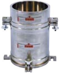
> CBR-Geräteanordnung für Laboruntersuchung
