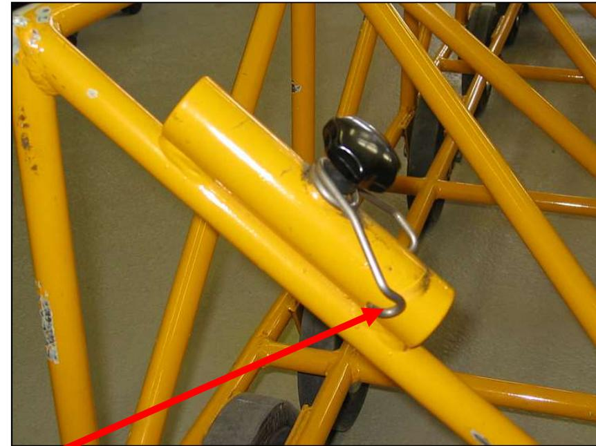
**Die Andruckfeder des Messrades wird entfernt.
