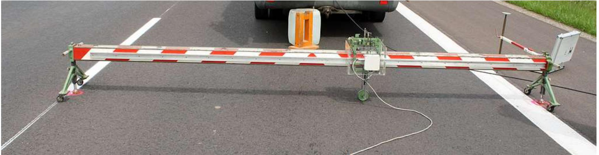
Der Profilograf dient der Erfassung von Abweichungen der Straßenoberfläche in Querrichtung zur Fahrbahnlängsachse.
